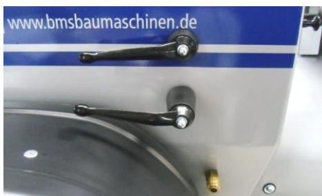
Ober- und Unterlufteinstellung
